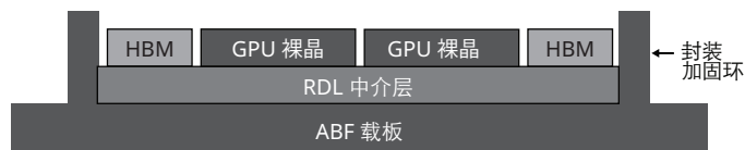
图 5：无金属均热盖封装结构剖面示意图
